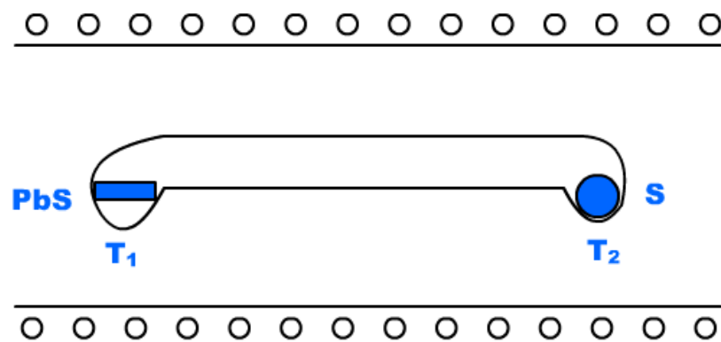
图6.2.9 两温区 PbS 灼烧装置
