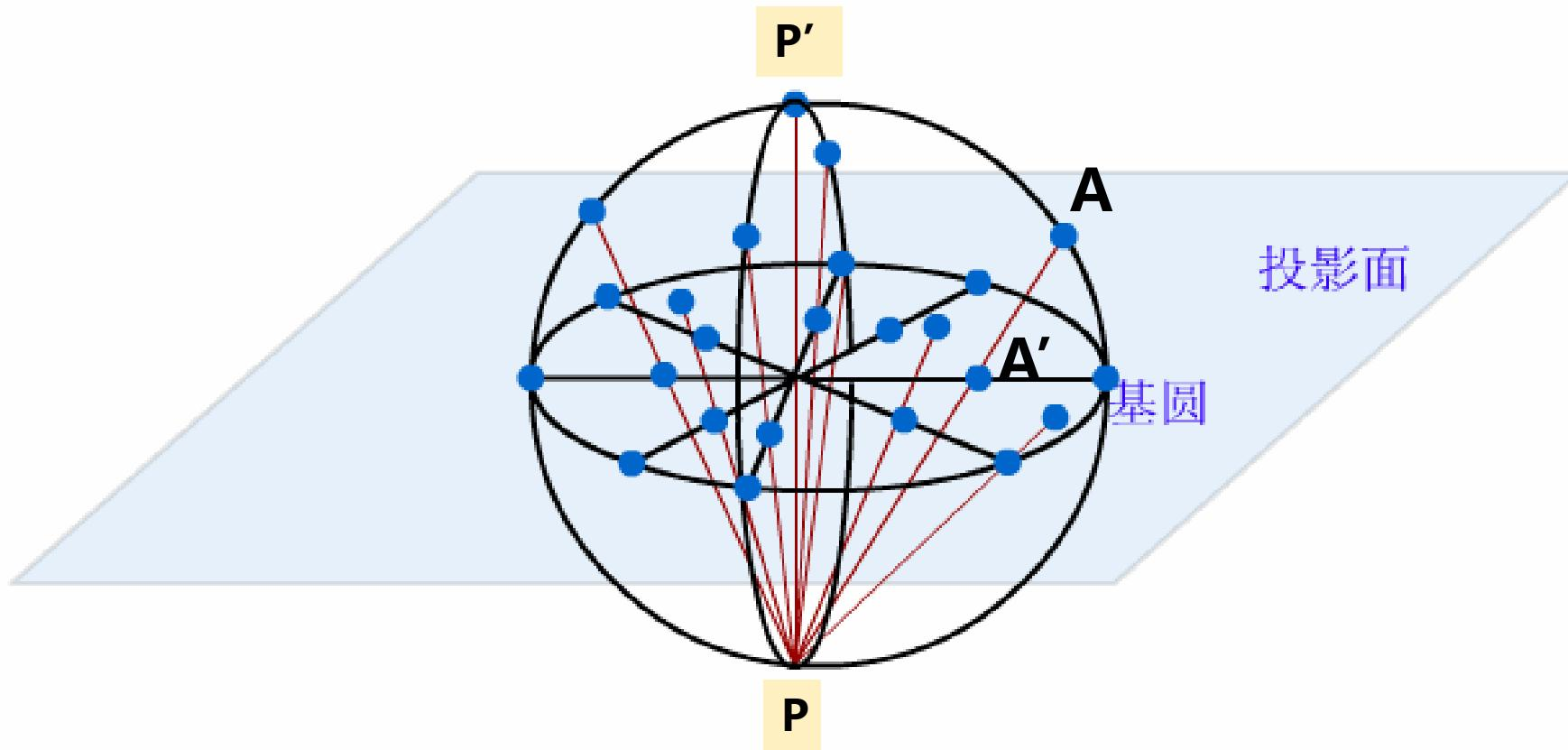
晶体点阵平面的球面投影极点在上半球以内者均可以投影到基圆以内，而在下半球面上的极点，则投影到基圆以外。愈近P点的极点，投影点距基圆圆心愈远。
