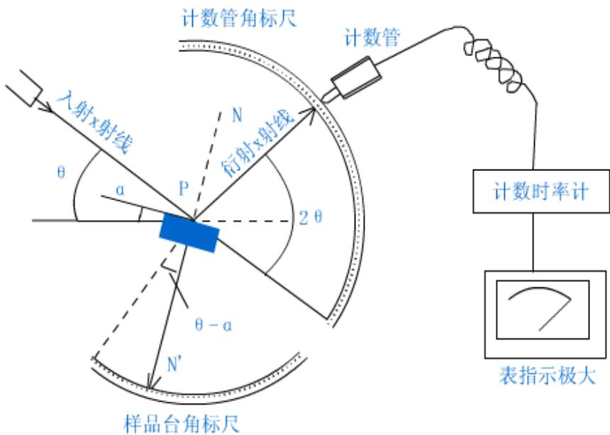
图4.7.1 单色x射线衍射法定向原理图
