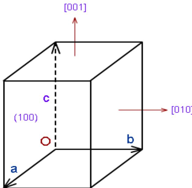
图4.5.5 表示属于两个晶带的晶带轴
