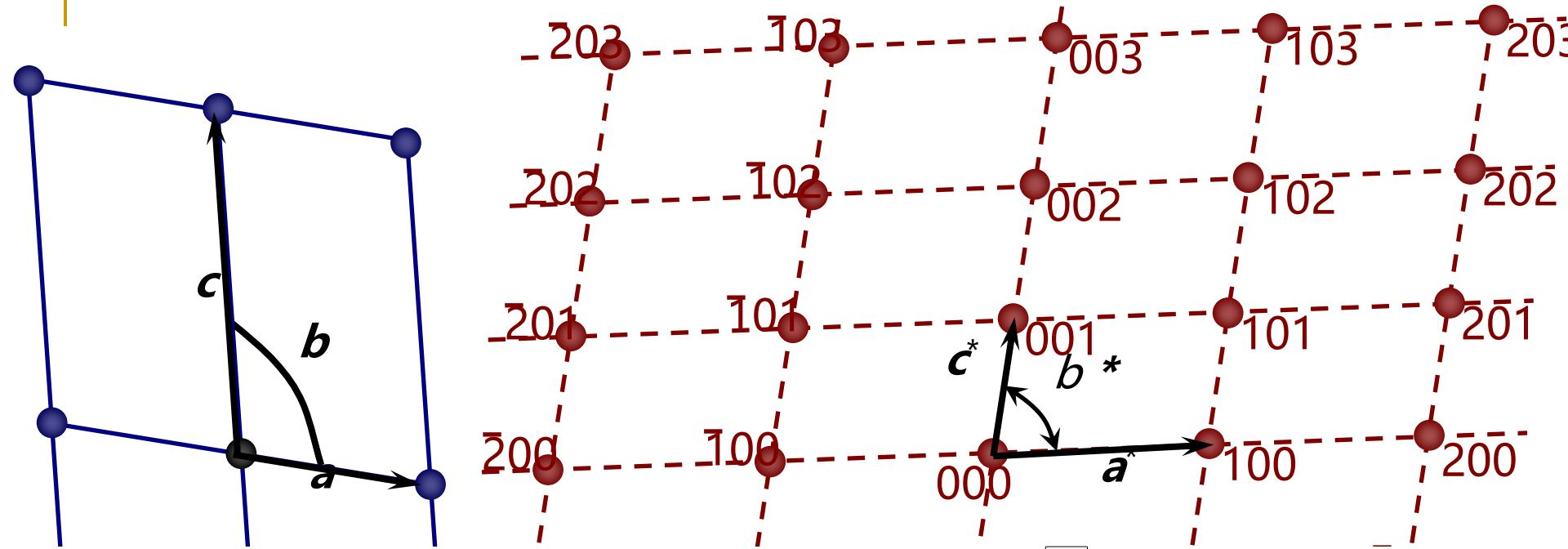
正格子：简单单斜格子， $a$ 、 $b$ 、 $c$ ， $\alpha = \beta = \gamma \neq 90^\circ$
