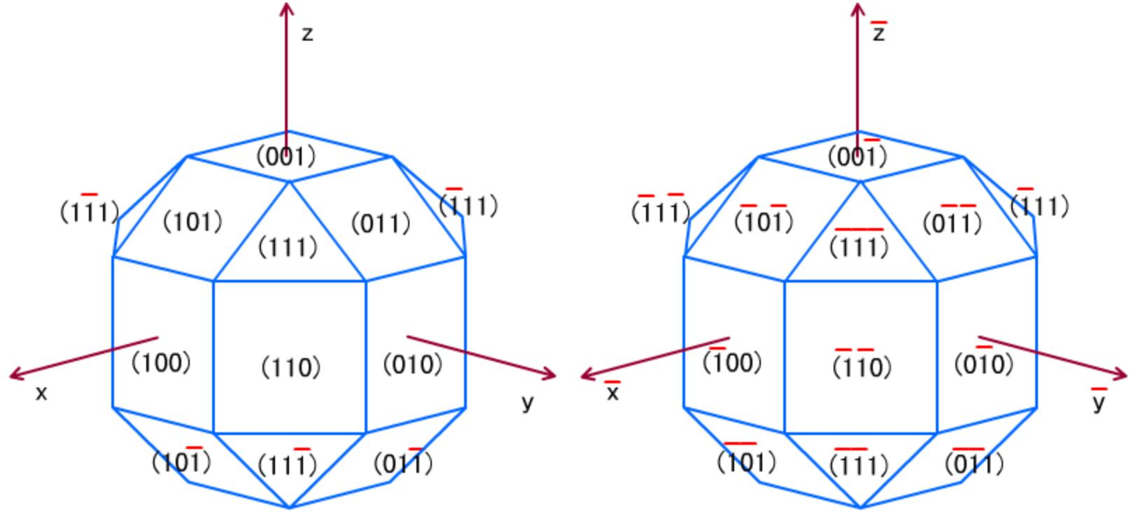
立方晶系中**六个**等同的{100}晶面，**十二个**等同的{110}晶面，
