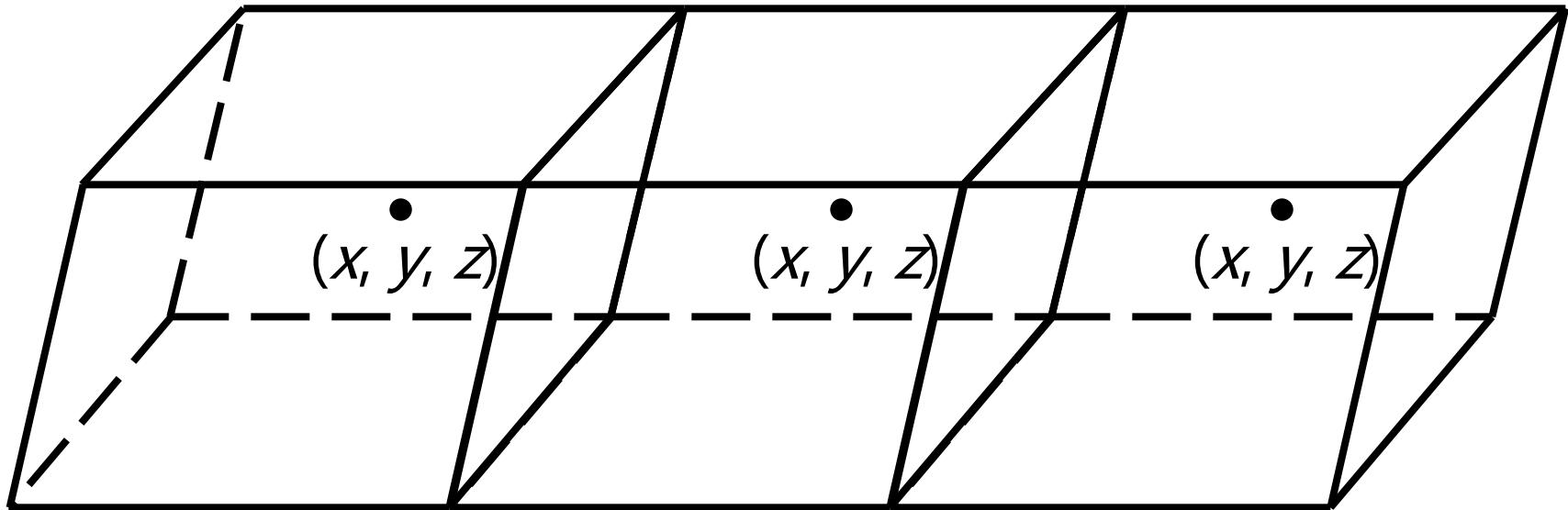
一个晶胞中具有某个原子坐标的原子，整个晶体中与之对称的原子也具有该原子坐标。
