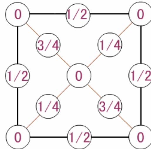
有时，也可以将原子的位置投影到晶胞结构的底面上，以数字标明它所在位置的高度。
