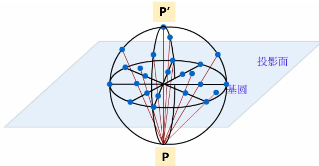
规律：参考球上的大圆投影到基圆上成为圆弧，其两端在基圆直径的两对点上。通过PP'的大圆其投影在基圆上成为直径。
