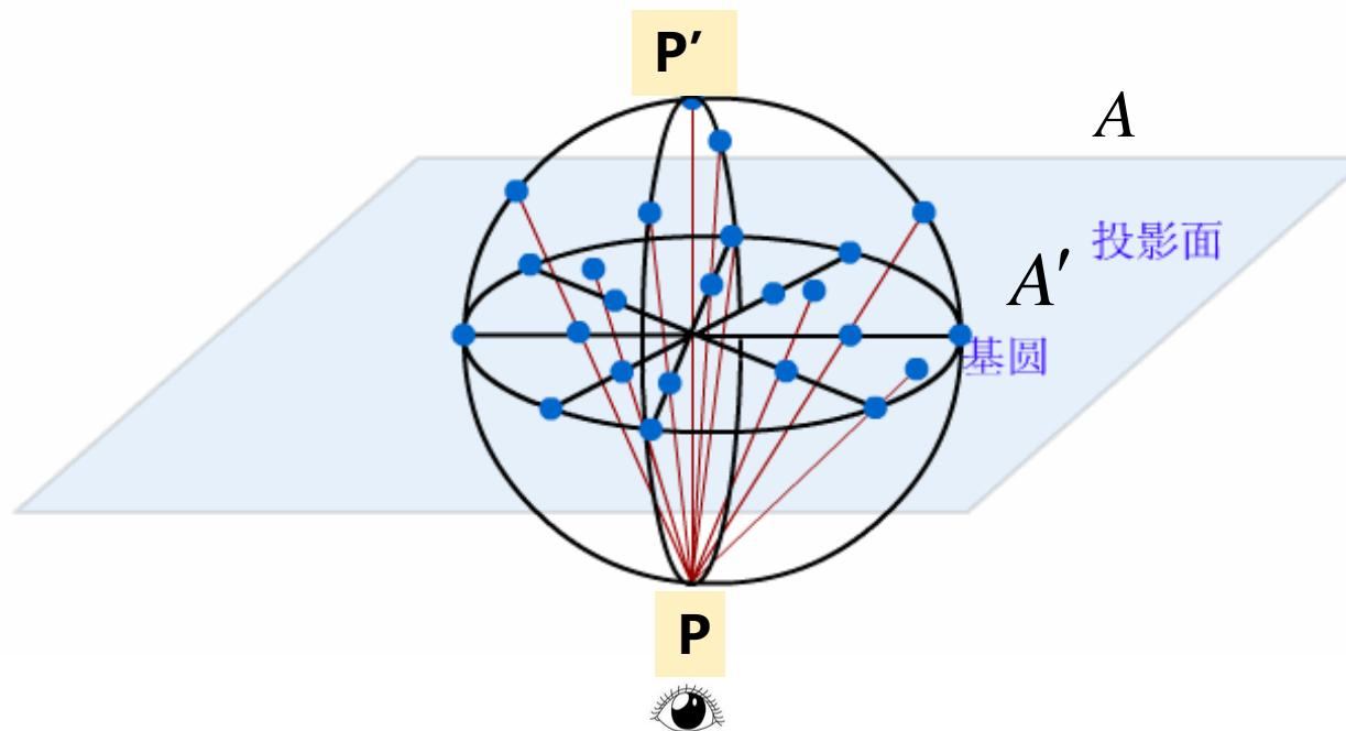
晶体上某一个晶面的法线与参考球面相交而成的A点，将投影到基圆上成为A'点。
