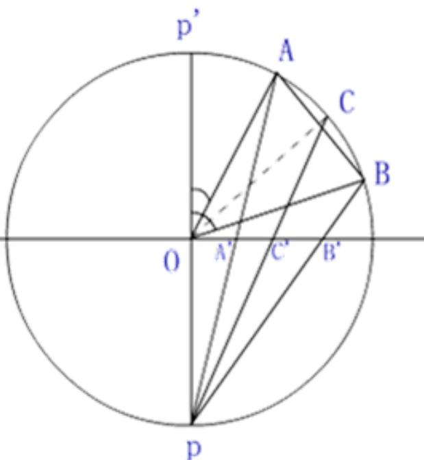
利用极射赤面投影的方法可以方便地把某一晶体的各个晶面的法线方向标记到赤平面上。对于立方晶系晶体晶向和晶面的法线方向是一致的，因此也就是把晶向标记到赤平面上，见图。图中○，□，△分别表示2重对称轴、4重对称轴、3重对称轴。
