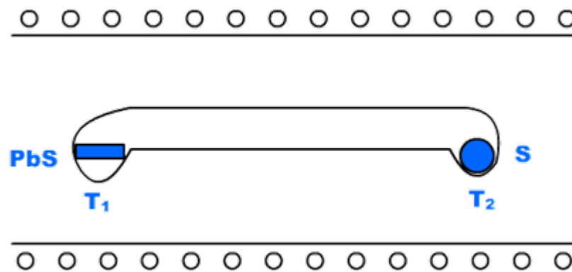
图6.2.9 两温区 PbS 灼烧装置
