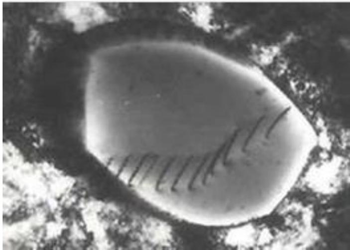
位错的透射电子显微镜照片
